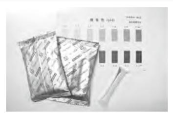
■COD 化学的酸素の消費量を調べる (5分で結果がでる。調理、洗たく、米のとぎ 汁、排水の調査)
