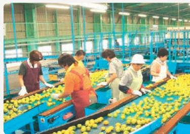
収穫されたみかんは選果場で手作業で選別された後、光センサーを通じ56通りの等階級に選別されます
